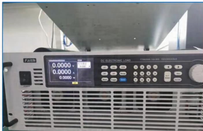
6KW DC load
